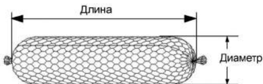
Рисунок 4. Конструктивная схема габионной конструкции цилиндрической
